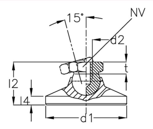
d1 = 32 d2 = 10 l2 = l4 = -NV = 15 Static load (kN) = 23 t min = 10.5
